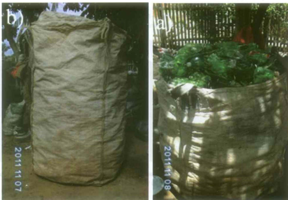
Figura 10. a) Fardo de embalagens de óleo lubrificantes ao sair da prensa; b) Fardos de embalagens de óleo revestidos com papelão para evitar o contato direto dos resíduos com os outros fardos.
