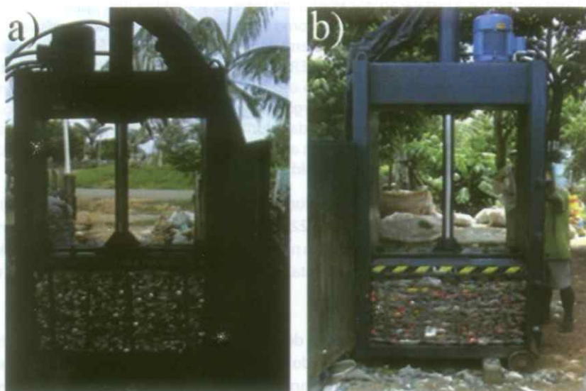
Figura 11. Prensa hidráulica PHV 150 usada para embalar os materiais recicláveis em fardos de 80 kg, a) prensando latinhas b) prensando PET.
