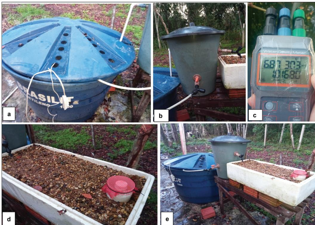
Figura 01: a- Ambiente de criação de organismos aquáticos; b- Filtro de sólidos em suspensão; c- Equipamento multiparâmetro para verificação de qualidade de água; d- Cama de cultivo com dreno via sifão sino; e- Vista geral do sistema de aquaponia. Fonte: próprio autor, 2018.
