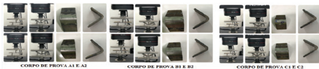
Figura 3: Processo de ensaio de flexão e resultados dos corpos de prova
