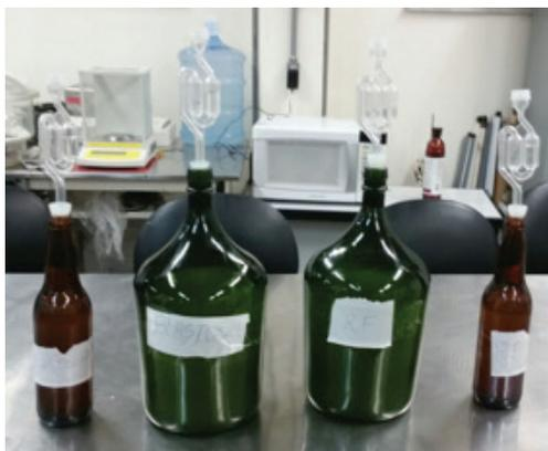
Figura 2. Garrafas de vidro munidas de válvula airlock utilizadas como fermentadores.
