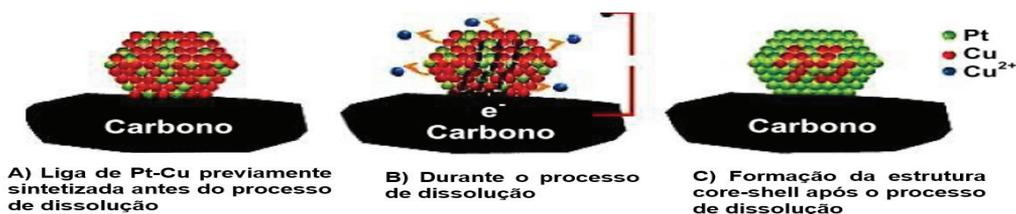
Figura 5: Processo de obtenção do catalisador Pt-Cu/C com estrutura tipo *core-shell* segundo Mani et al. (2008).
