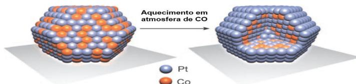
Figura 6: Método de obtenção de estrutura tipo *core-shell* descrito por Mayrhofer et al. (2009), a partir de uma liga de Pt-Co.
