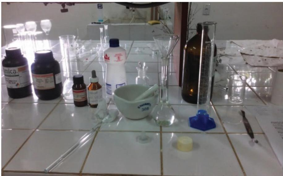
Figura 2: Materiais utilizados para sintetizar o extrato: almofariz com pestilo, funil, béquer, argola, papel de filtro, bastão de vidro e espátula.
